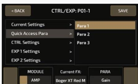
Воспользуйтесь регулятором быстрого доступа 1, чтобы выбрать управляемый модуль. Если вы хотите отключить регулятор быстрого доступа, на панели параметров выберите OFF:
